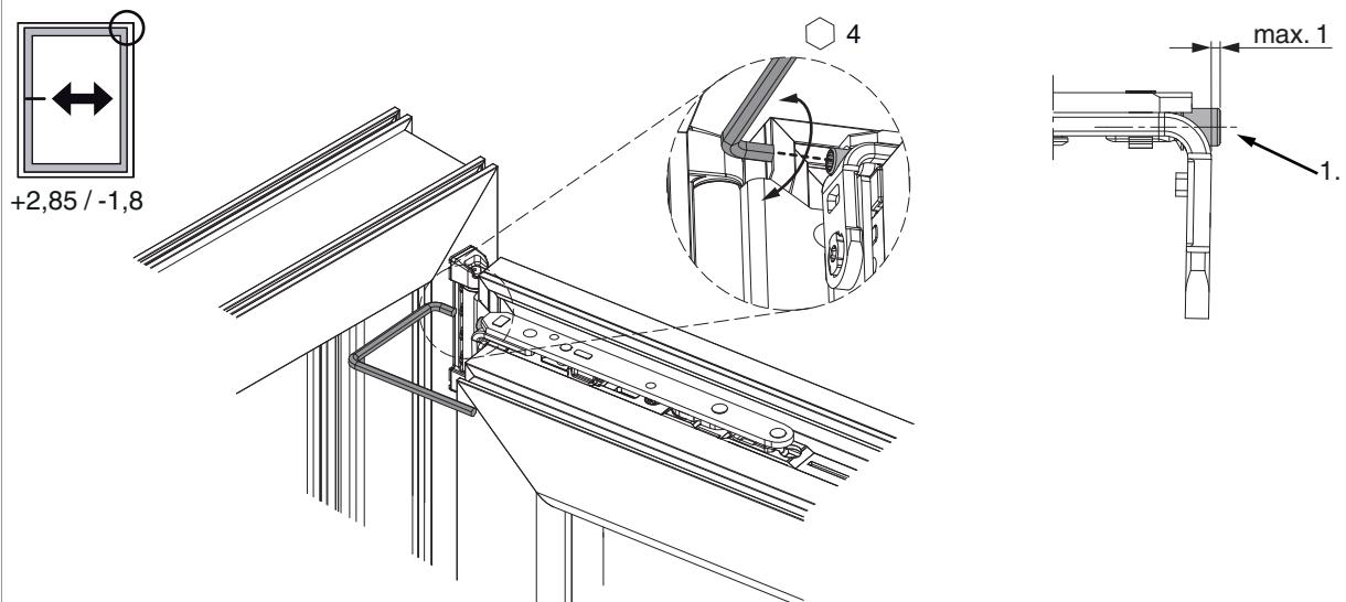
1. Beim Absenken des Flügels darauf achten, dass die Schraube nicht komplett herausgeschraubt wird. Der Schraubenkopf darf maximal 1 mm vorstehen!
