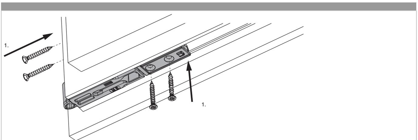
1. Ecklagerband in Beschlagsnut einsetzen, vorbohren (nur bei Holz) und verschrauben.
