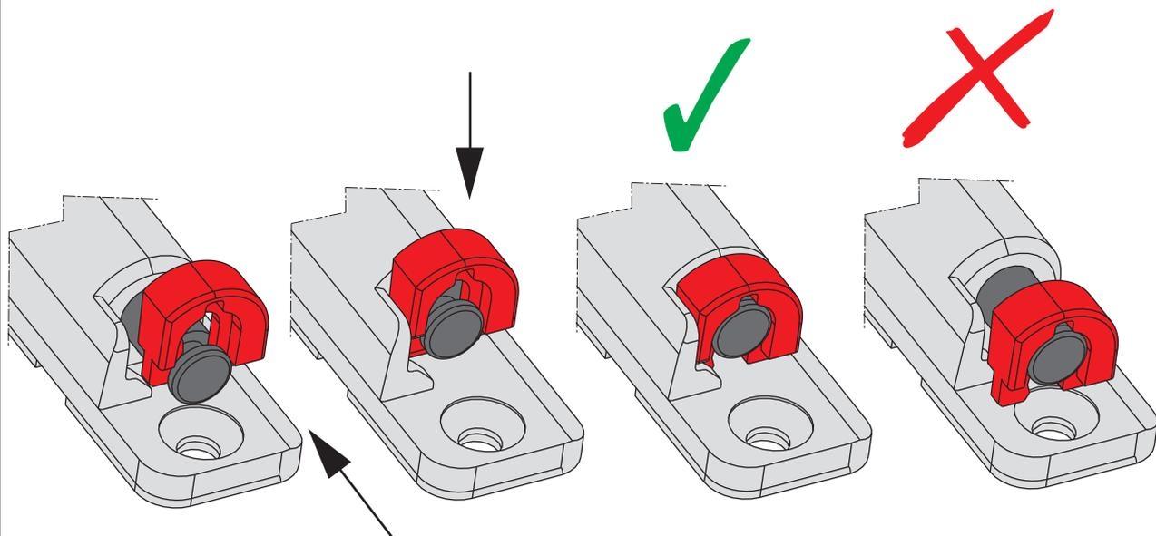
Nach vollständigem Einschieben des Scherenlagerstiftes (→ bis auf Anschlag) die Stiftsicherung laut Abbildung einklipsen!
