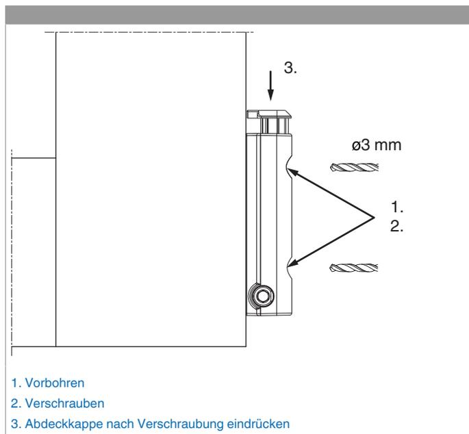
Das Ecklagerband TO mit ÜV an den Überschlag anlegen, die beiden Löcher am Überschlag vorbohren und verschrauben.
