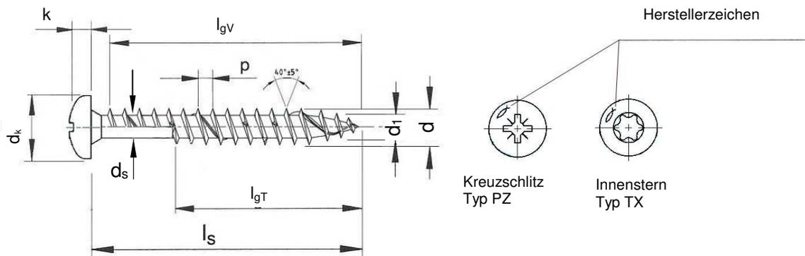
**Selbstbohrende Schraube (Pan head) mit Voll- oder Teilgewinde**
