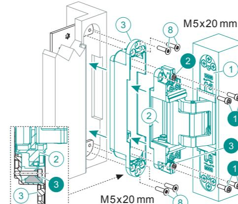
**DE** TE 540 3D FZ/1 rückseitig an der Zarge verschrauben. Je nach Zargenkonstruktion beiliegende Distanzplättchen verwenden. Die Aufnahme (3) mit den 4 Schrauben (8) an TE 540 3D FZ/1 befestigen (8 Nm). Das Band-Rahmesteil (2) in (3) einsetzen und mit den 4 Schrauben (1) befestigen (8 Nm). (2) und (3) eindrehen.
