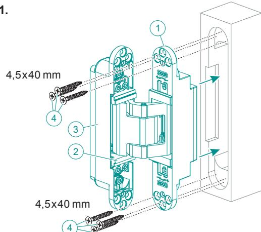
**DE** Das Band-Flügelteil (1) in den Türflügel einsetzen, den Türflügel vorbohren und das Band-Flügelteil mit den 6 Schrauben (4) befestigen.
