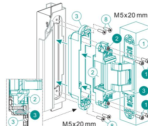
**DE** Die Stahlzarge muss mit TE 540 3D A8 SZ ausgestattet sein (8 Nm). Die Aufnahme (3) mit den 4 Schrauben (8) an TE 540 3D A8 SZ befestigen (8 Nm). Das Band-Rahmesteil (2) in (3) einsetzen und mit den 4 Schrauben (1) befestigen (8 Nm). (2) und (3) eindrehen.
