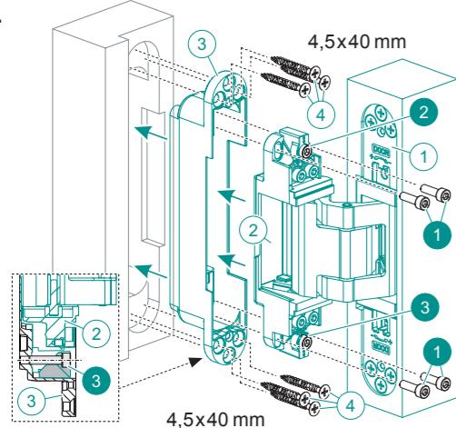
**DE** Die Aufnahme (3) in die Zarge einsetzen, die Zarge vorbohren und die Aufnahme mit den 6 Schrauben (4) befestigen. Das Band-Rahmesteil (2) in die Aufnahme einsetzen und mit den 4 Schrauben (1) befestigen (8 Nm). Introduce (2) and (3).
