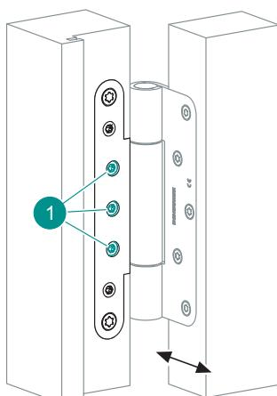
**□ Andruckverstellung / Depth adjustment /
