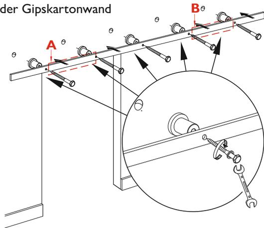
Vor der Montage der Laufschiene an den Wandbefestigungen müssen die Endstopper in den äußeren Feldern **A** und **B** platziert werden
